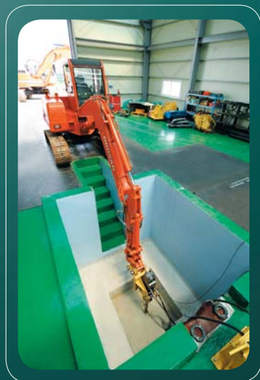
Essai installé sur la base d'impact avec ses jauges de contraintes, de débit et de pression à la sortie des flexibles du vérin.
